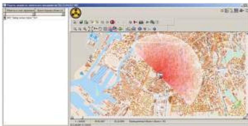
Рис. 2 П. 4. Результаты моделирования аварии на химически опасных объектах (по РД 52.04.253–90)
